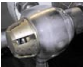
TDA test utfört av Svenska Marinen. Vattentemperatur 1°C, andningsarbete 75l/min och 70 meters djup.
